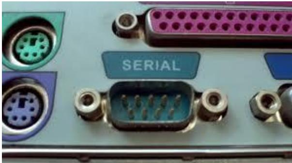
Cette connectique est fréquemment utilisée dans l'industrie pour connecter différents appareils électroniques (automate, appareil de mesure, imprimante, etc...)
